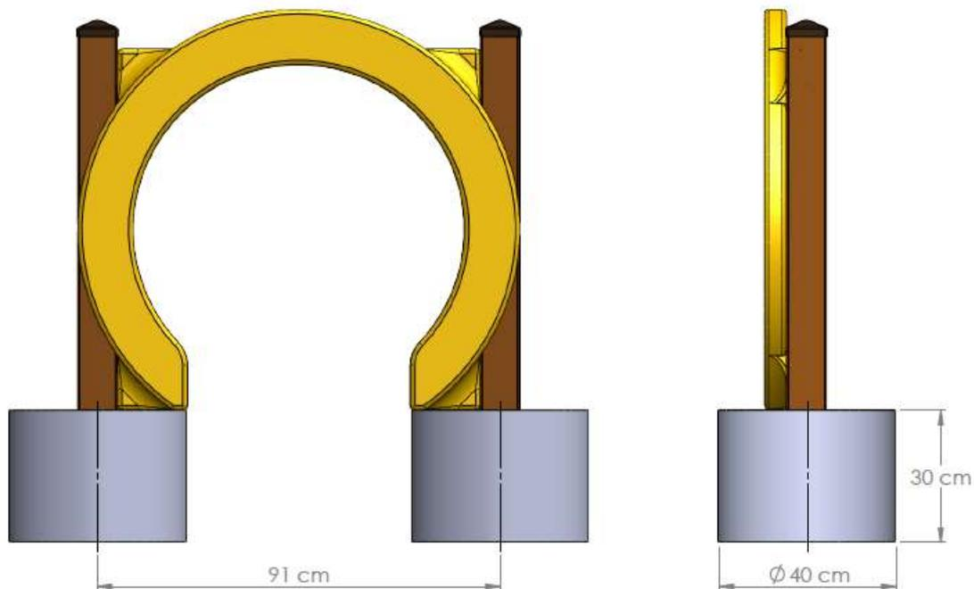
Em seguida realize a mistura do concreto e preencha as fundações, adicione o equipamento nas fundações com o cimento fresco, mantenha o equipamento sempre bem alinhado.
