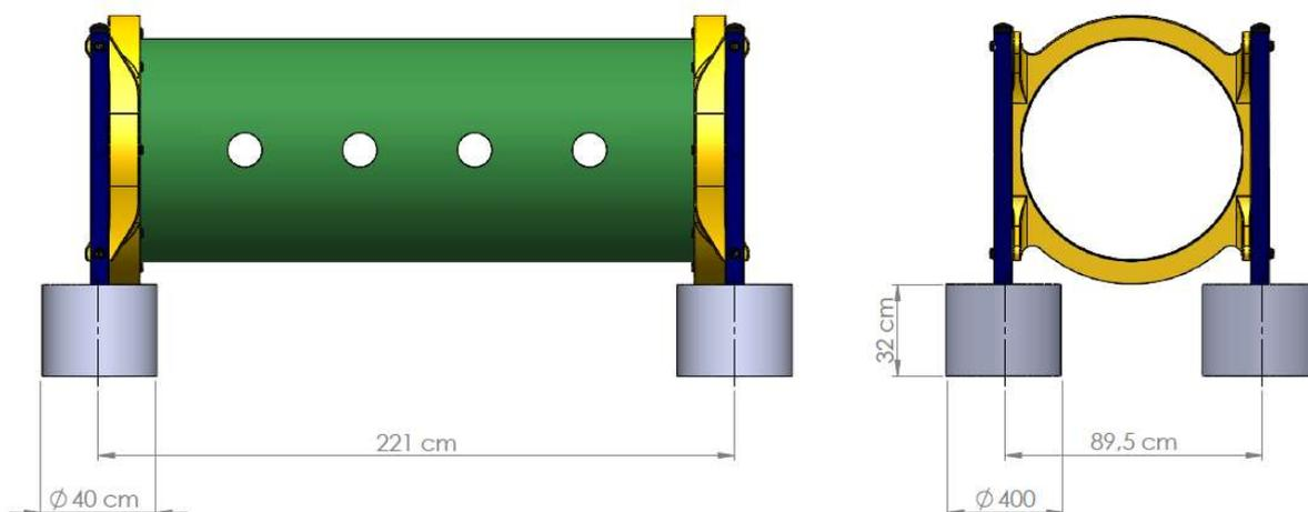
Segundo passo, realize a mistura do concreto com os materiais listados acima; Preencha a fundação com a mistura e com o auxílio do nível manter o equipamento alinhado.
