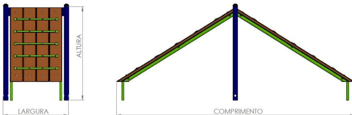
**Possui 1012 mm de altura, 702 mm de largura e 2550 mm de comprimento, pesando 42,5 kg.**
