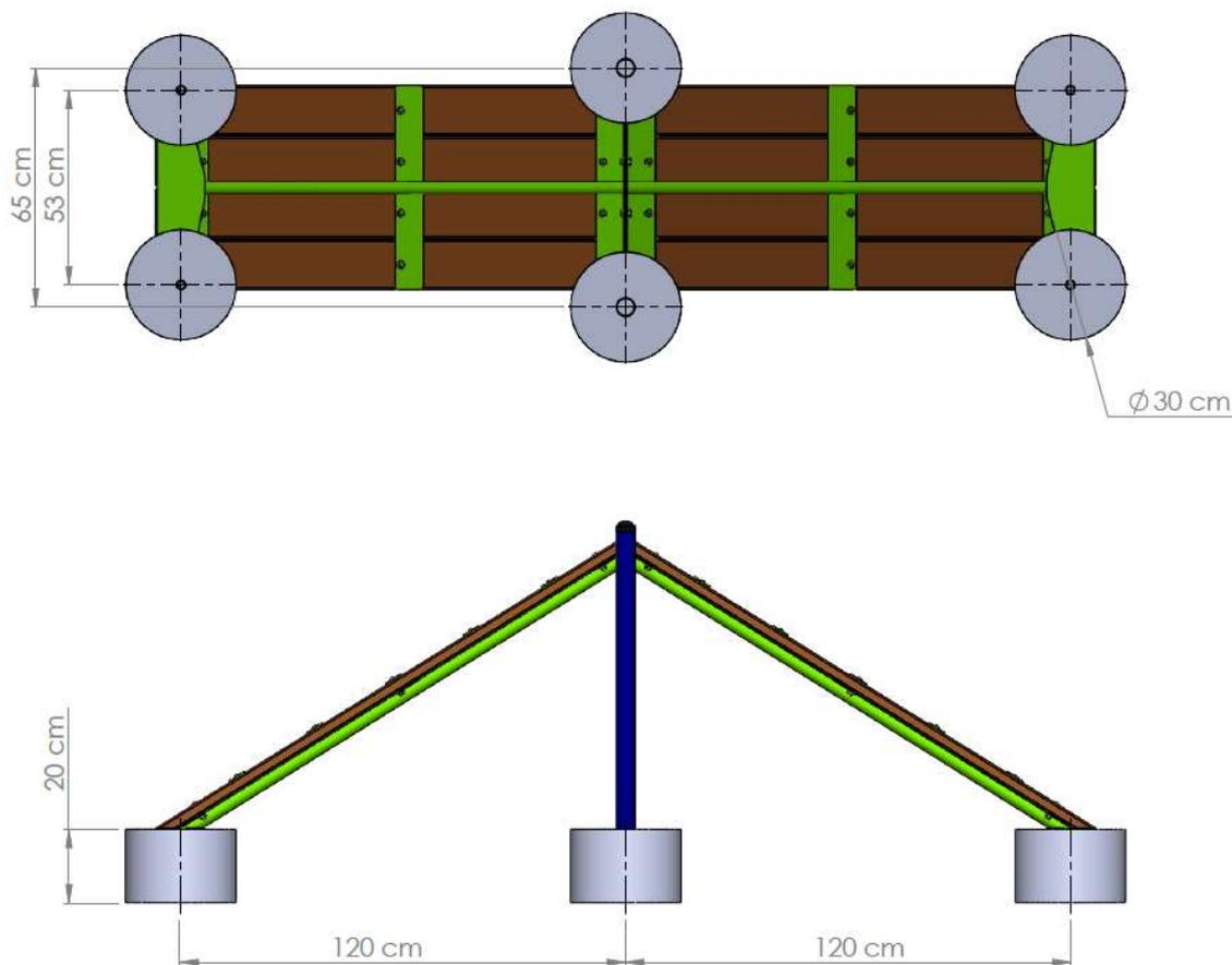
Segundo passo, preencha as fundações com concreto e terra conforme imagem acima, utilize o nível para que o equipamento fique alinhado.
