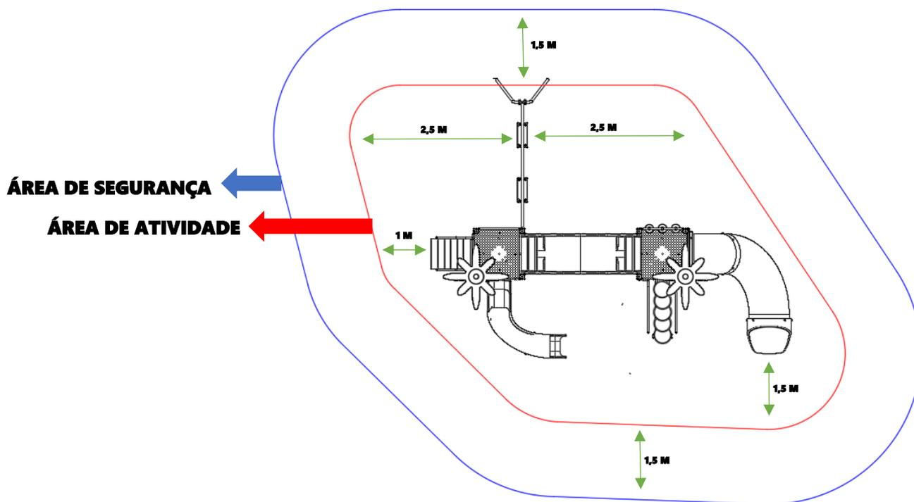
Segundo a norma é necessária uma distância de 1 metro em volta do equipamento para a realização das atividades e uma distância de 1,5 metros em volta da área de atividade para a área de segurança.
