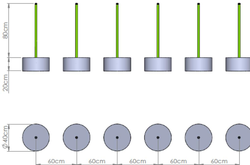
Segundo passo, preencha as furações com concreto e terra conforme imagem acima, utilize o nível para que o equipamento fique alinhado.
