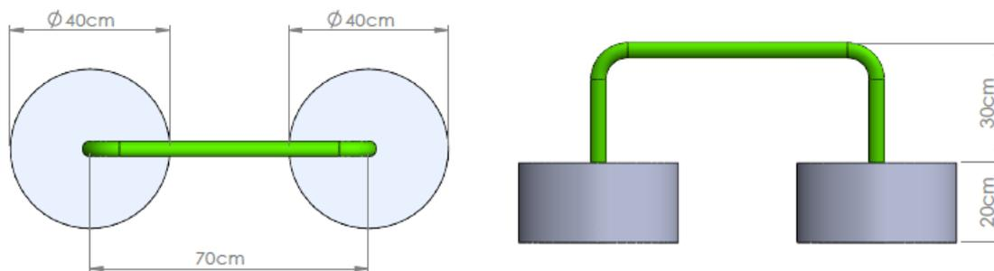
Segundo passo, preencha as fundações com concreto e terra conforme imagem abaixo, utilize o nível para que o equipamento fique alinhado.
