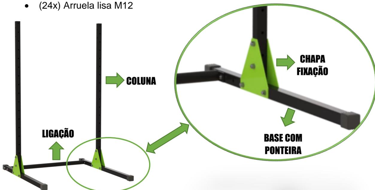
Para a montagem do equipamento serão necessárias 02 chaves de boca sextavada tamanho 19 para o aperto das porcas e parafusos.
