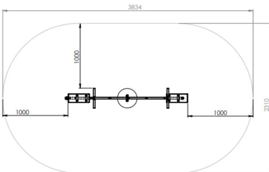
Se existir a transição de pedestres e adicionamento o comprimento de 1,5 metros cada lado em relação a área de funcionamento, totalizando em uma área de segurança de 3,3 metros de largura por 4,8 metros de comprimento, totalizando em 15,8 metros quadrados.
