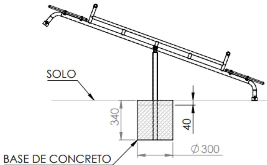
Posicionar o brinquedo no buraco feito, e observar o alinhamento do equipamento, a estrutura precisa estar inclinada a  $20^\circ$  em relação ao solo, e o amortecedor de borracha precisa estar alinhado com o solo.
