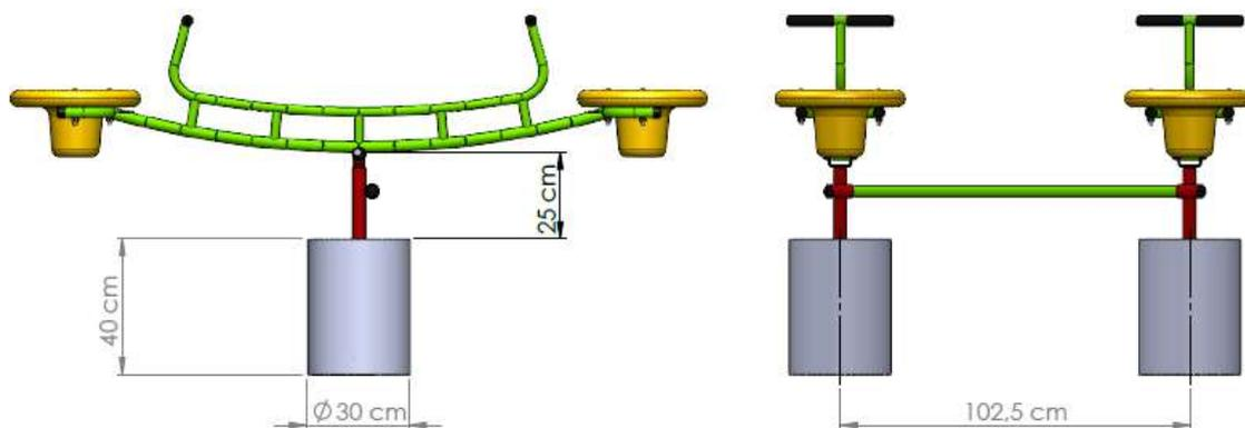
Em seguida realize a mistura do concreto e preencha as fundações, adicione o equipamento nas fundações com o cimento fresco, mantenha o equipamento sempre bem alinhado.
