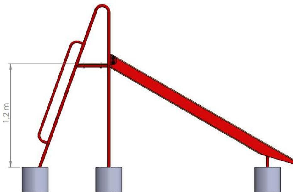
**O concreto não pode ficar visível, sempre finalize a instalação colocando o amontoado de terra acima da base de concreto, para que as crianças não se machuquem.**
