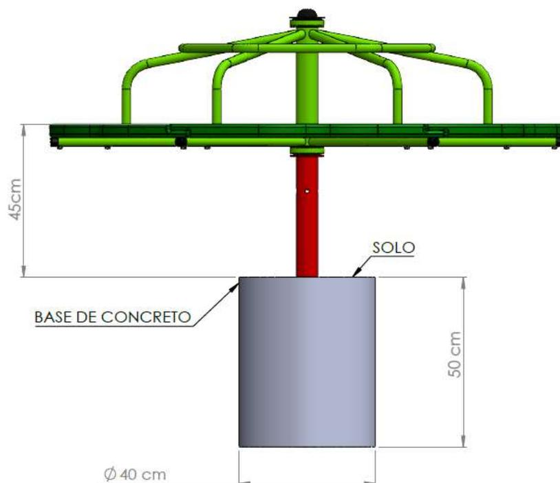
O concreto não pode ficar visível, sempre finalize a instalação colocando o amontoado de terra acima da base de concreto, para que as crianças não se machuquem.
