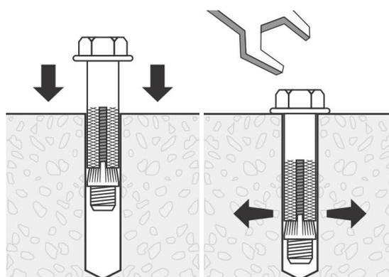
**Quarto passo:** Remova o parafuso, posicione o equipamento nas furações e parafuse novamente, prendendo o equipamento no concreto.
