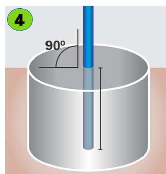
**O concreto não pode ficar visível, sempre finalize a instalação colocando o amontoado de terra acima da base de concreto, para que as crianças não se machuquem.**
