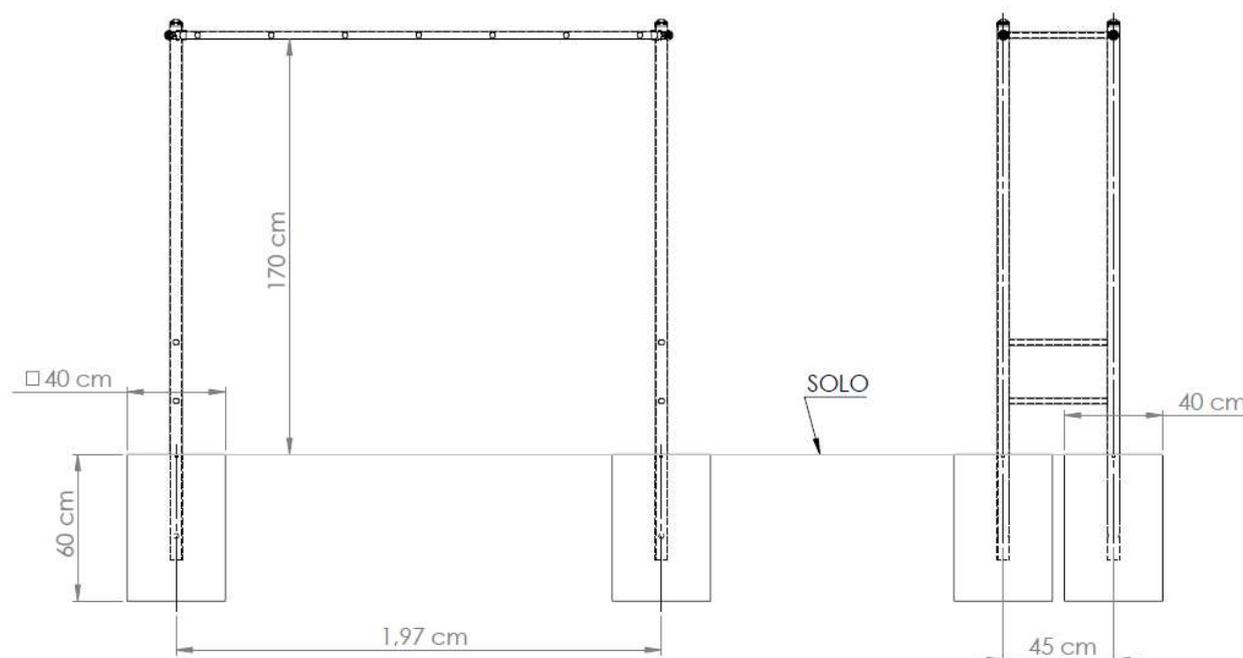
Segundo passo, realize a mistura do concreto com os materiais listados acima; Preencha a furação com a mistura e com o auxílio do nível manter o equipamento alinhado.
